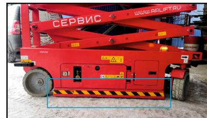
с. В случае непредвиденной ситуации, принудительный спуск осуществляется с помощью рычага, установленного в нижней части подъемника (потянув его на себя).
